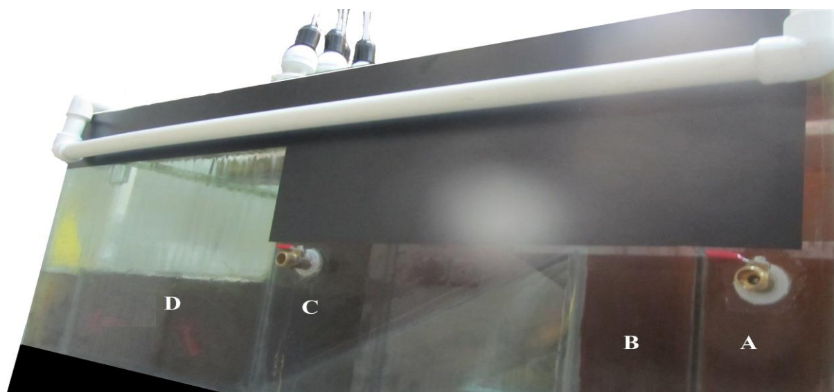
شکل ۱. نمای روبرو از سیستم طراحی شده؛ بخش‌ها به ترتیب شامل: جداساز کف و مواد روغنی، رسوب گیر، تله مواد معلق و بیودراف.
