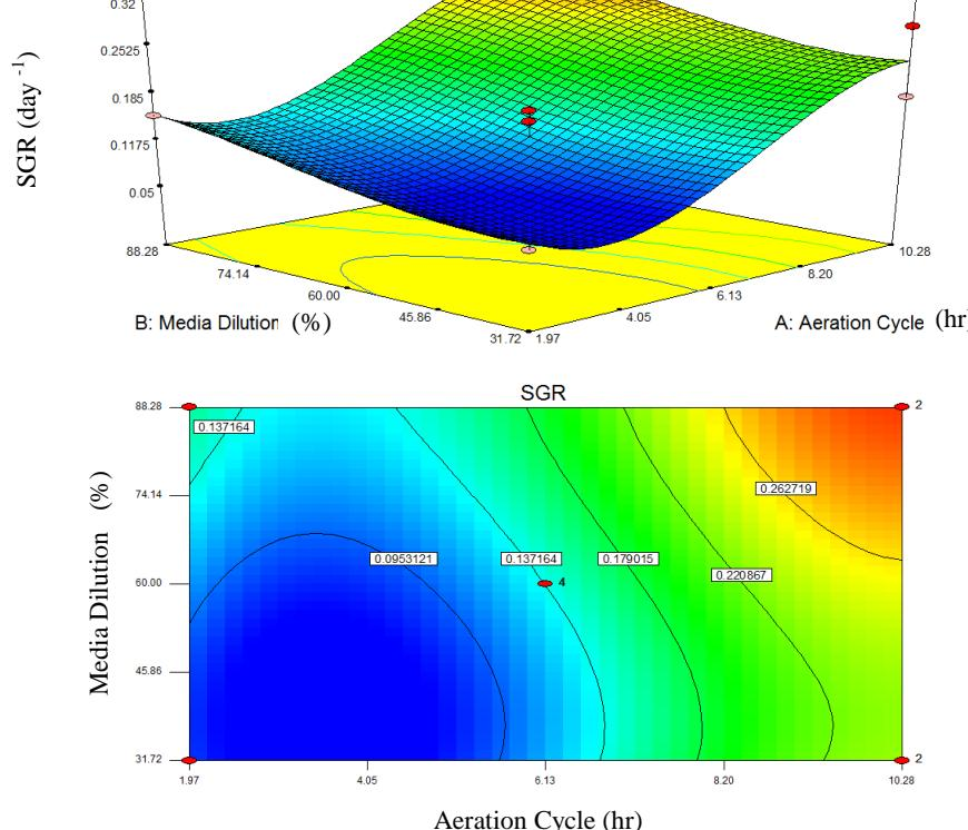
شکل ۱. تأثیر فاکتورهای غلظت محیط کشت و سیکل هوادهی بر میزان نرخ رشد مخصوص؛ بالا: تصویر سه‌بعدی، پایین: کانتورهای دو بعدی
