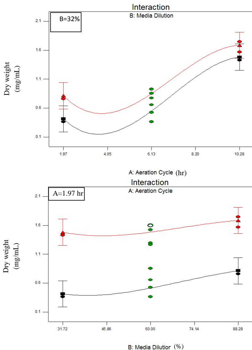
شکل ۲. برهم‌کنش تأثیر فاکتورهای غلظت محیط و سیکل هوادهی بر میزان وزن خشک؛ بالا: اثر هوادهی، پائین: اثر محیط کشت
